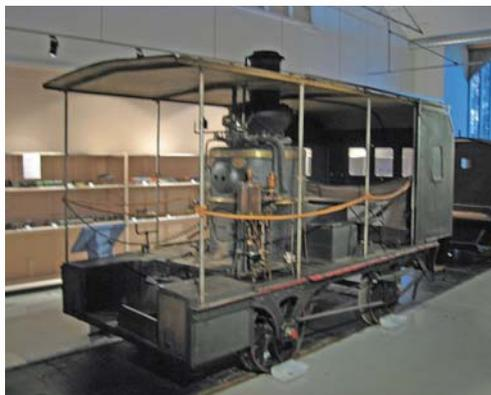
*Im SJ-Bahnmuseum Ängelholm werden wichtige Bahneinrichtungen gezeigt, wie etwa dieser dampfbetriebene Bau-diensttraktor*
